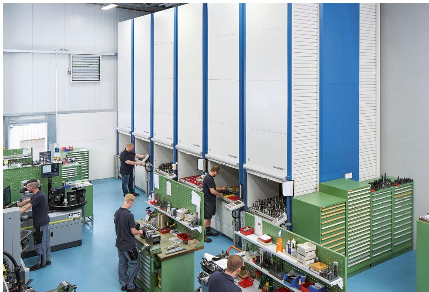
Инструментальный склад из шести систем Hänel Lean-Lift® повышает скорость поиска и выдачи инструмента
