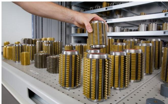
Компактное хранение зуборезного инструмента
